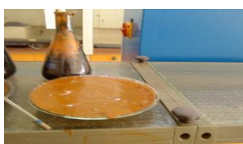
Figure 3. Diatomite modifiée par le fer (DMF4) après l'agitation et l'oxydation par l'air.
