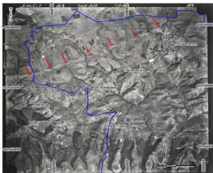
Figure 1. Linéament de la faille de Mahelma vu sur une photographie aérienne au 1/20 000. Le polygone bleu représente le périmètre de la ville nouvelle de Sidi Abdallah. Les flèches rouges localisent le linéament.
