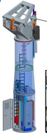
Cinématique robuste, fiable et à faible impact CEM permettant de positioner avec une grande précision la parabole
